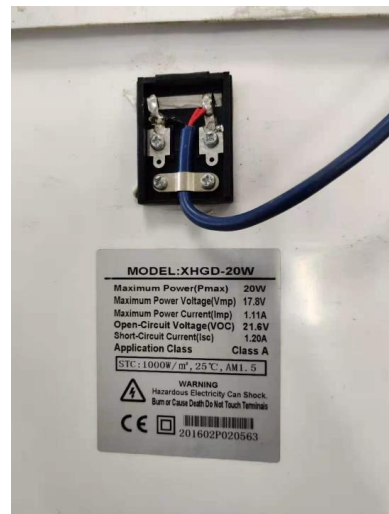
图 太阳能板接线端
